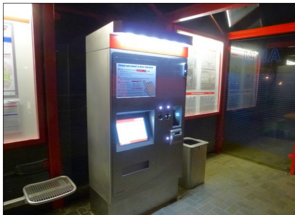
Abbildung 41: Die Bildschirme in den neuen Automaten der AKN sind relativ niedrig platziert. Auch in Nützen ist die Bedienung dadurch erschwert. Die Bildschirmunterkante befindet sich dort nur 84 cm über der Bahnsteigoberfläche.
